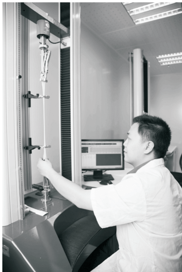
安安公司研发人员利用电脑伺服拉力机测试合成革弹性
